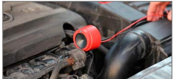
**Fehlerbehebung:** Leuchtdiode blinkt nicht → Spannung überprüfen / Polarität der Kabel kontrollieren
