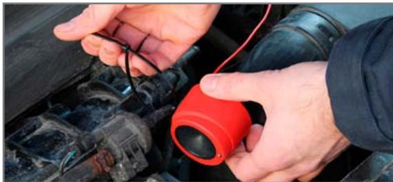
2. Gerät mit Kabelbinder im Motorraum befestigen.
